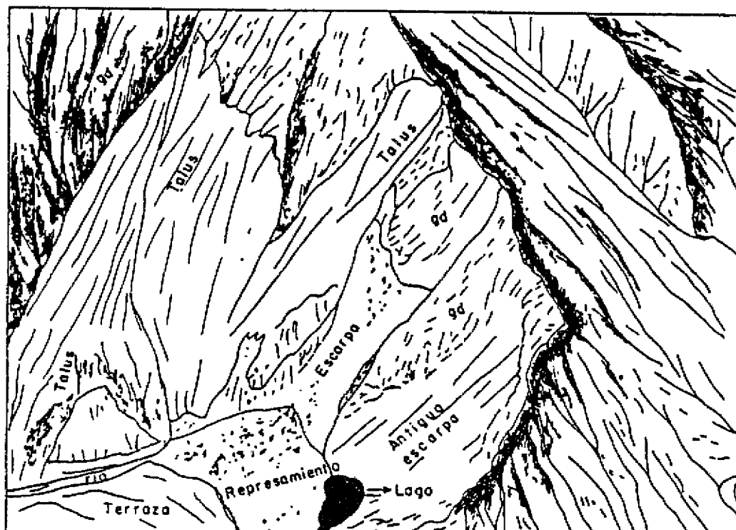
Fig. 2_ CROQUIS DEL DESLIZAMIENTO, BASADO EN FOTOGRAFÍAS AERÉAS. (SNOW, 1964).
